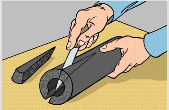
Die Schnittflächen werden verklebt, so daß sich der Schlauchdurchmesser reduziert.
